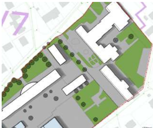
Modéliser les ombres portées des bâtiments fait partie d'une des étapes pour calculer le score ICU.
